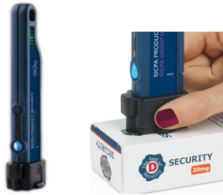
Figura 12 – Ilustrim i detektorit shënjes HD20 SICPAGUARD® dhe përdorimit të tij
