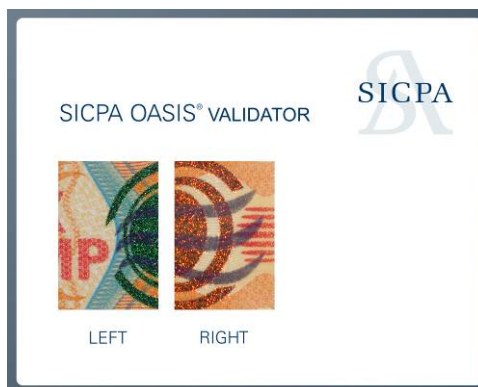
Figura 11 – Efekti polarizues SICPA OASIS® i autentifikuar nga një filtër VA11
